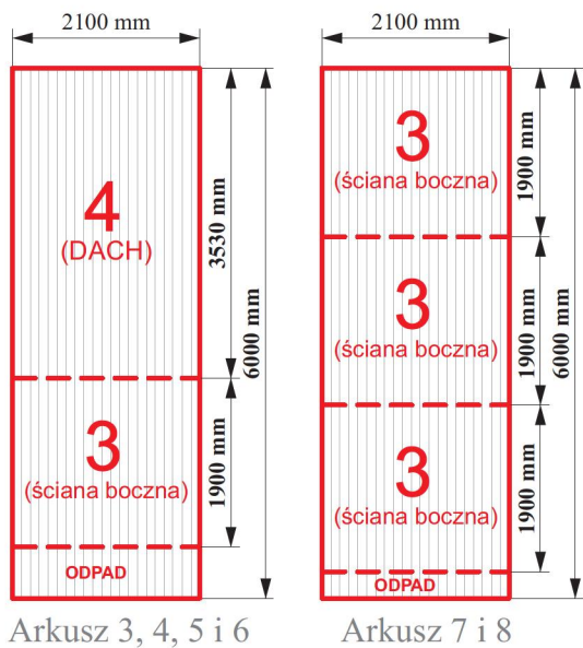
Rys. 22 - Cięcie poliwęglanu na szklarnię 10-metrową
